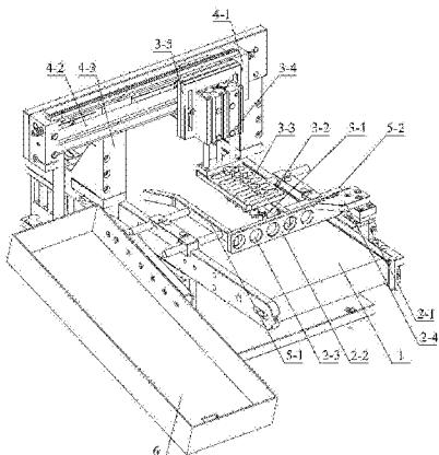
1. 一种CCD检测机的抓取装置,其特征在于,包括部品吸附装置(3)、料盒(6)、用于将部品遮挡在部品吸附装置(3)下方的部品遮挡装置(2)及用于带动所述部品吸附装置(3)沿传输带(1)宽度方向移动,且使得部品能够位于所述料盒(6)上方的搬运装置(4),所述料盒(6)位于传输带(1)侧面;
