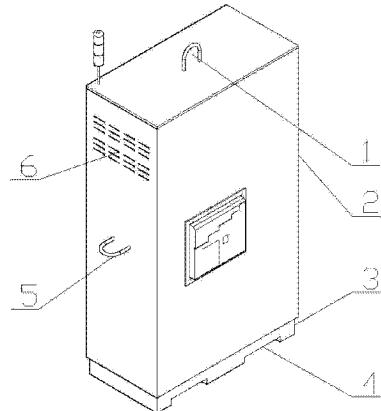
1. 一种便于搬运的配电柜,包括柜体(2),柜体(2)为长方体结构,其特征在于:所述柜体(2)下方设置有底座(3),底座(3)上开设两条便于叉车搬运的叉脚槽(4),叉车的叉车底脚深入到叉脚槽(4)内进行搬运;
