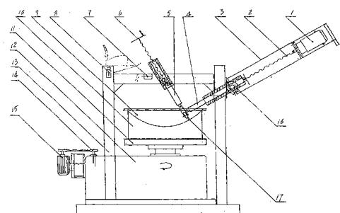
1、封头旋压机，它有机架（13），其特征在于：机架（13）上安装旋转盘（11），旋转盘（11）上安装封头模座（10），机架（13）一侧倾斜安装移动导轨（3），移动导轨（3）上安装径向移动导轨轴承座（16），机架（13）上端倾斜安装轴向移动推杆（5），轴向移动推杆（5）与轴向移动丝杆（6）连接，轴向移动推杆（5）端头安装旋压滚（17）。
