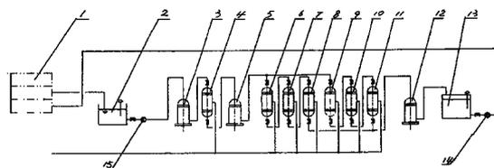
1. 电镀生产线节水装置,包括原水槽(2)和工艺槽(1);其特征在于还包括第一精密滤器(3)、炭滤器(4)、第二精密滤器(5)、阳床、阴床、第三精密滤器(12)和回用水槽(13),工艺槽(1)的高度高于原水槽(2),工艺槽(1)通过管道与原水槽(2)连通;原水槽(2)、工艺槽(1)、第一精密滤器(3)、炭滤器(4)、第二精密滤器(5)、阳床、阴床、第三精密滤器(12)和回用水槽(13)的顶部和底部分别有进口和出口,原水槽(2)的出口与第一精密滤器(3)的进口间、第一精密滤器(3)的出口与炭滤器(4)的进口间、炭滤器(4)的出口与第二精密滤器(5)的进口间、第二精密滤器(5)的出口与阳床的进口间、阳床的出口与阴床的进口间、阴床的出口与第三精密滤器(12)的进口间、第三精密滤器(12)的出口与回用水槽(13)的进口间、回用水槽(13)的出口与工艺槽(1)的进口间均通过管道相连通;其中,原水槽(2)与第一精密滤器(3)间、回用水槽(13)与工艺槽(1)间分别有提升泵(15)和输送泵(14)。
