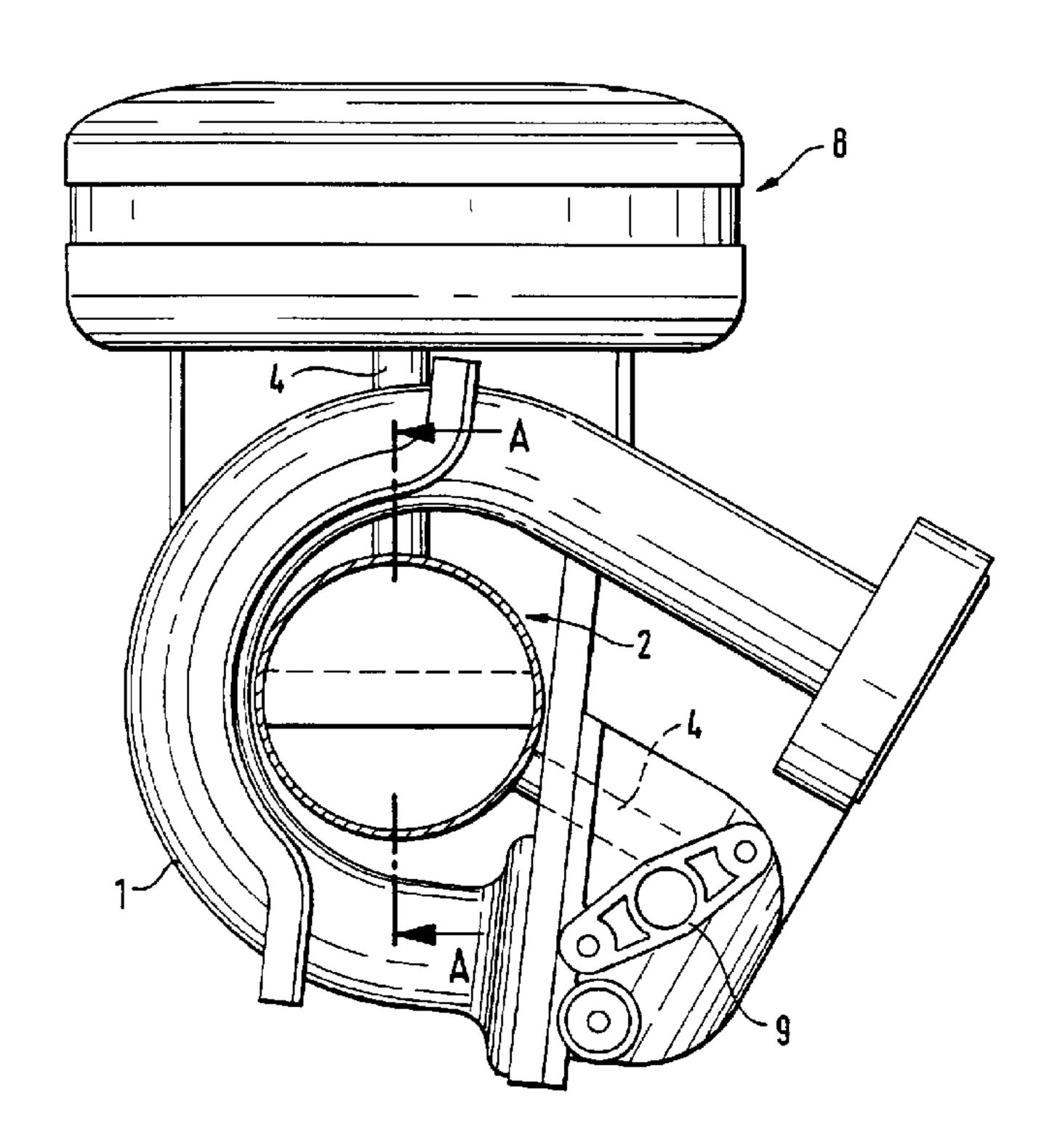
(57) L'invention concerne un module de tuyau, notamment dans la zone d'admission d'un moteur à combustion interne. Ce module de tuyau comporte au moins un tuyau (1) coudé où au moins un composant fonctionnel (2, 5, 6, 7) est disposé sensiblement dans la zone de courbure, notamment à l'intérieur de cette zone.
