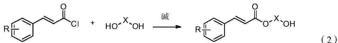
式 (2) 中, X 为  $-\text{CH}_2\text{CH}_2-$  或  $-\text{CH}_2\text{CH}_2\text{CH}_2-$ , R 为 H 或硝基;
