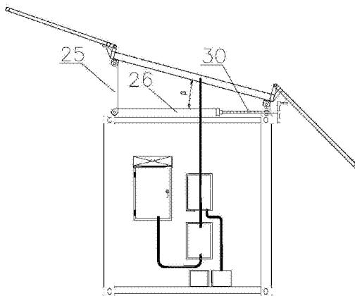
1. 一种集装箱，其特征在于，所述集装箱设置有可折叠支架和光伏发电系统，所述可折叠支架设置在所述集装箱的顶部，所述光伏发电系统包括光伏电池组件，所述光伏电池组件设置在所述可折叠支架上。
