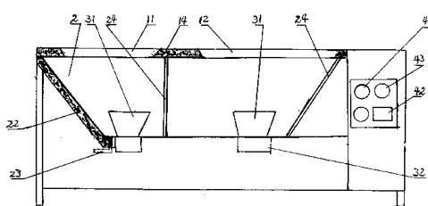
1、一种多功能美容薰蒸床，包括有床面板和支撑脚，其特征在于，它还包括有蒸汽室和1至3套蒸汽发生装置；
