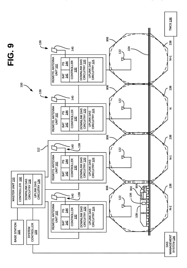
TMCS 136 140 REMOTE ANTENNA UNIT 102 DOWNLINK DAS CIRCUITRY 120 UPLINK DAS CIRCUITRY 124 CONTROLLER 132 PS 144 BAT 142 OFFSET DISTANCE CONTROLLER 132 DOWNLINK DAS CIRCUITRY 118 MASTER UNIT 110 UPLINK DAS CIRCUITRY 126 140 REMOTE ANTENNA UNIT 102 UPLINK DAS CIRCUITRY 124 DOWNLINK DAS CIRCUITRY 120 CONTROLLER 132 PS 44 108 BAT 142 BASE STATION 116 SYSTEM CONTROLLER <u>133</u> DAS MANAGEMENT SYSTEM <u>134</u>
