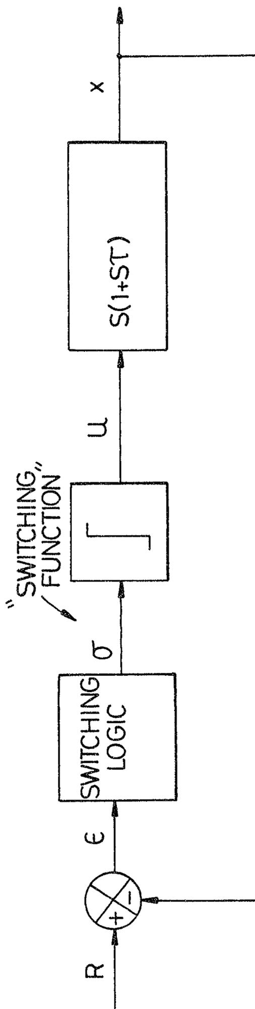
Fig. 3 DIRECT ON/OFF SYSTEM
