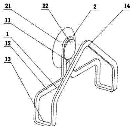
1. 一种洗碗布的搁置架,包括架体(1)及吸盘(2),其特征在于:所述架体(1)通过横杆(12)折弯成型,架体(1)包括两侧的凹形架(13)、后部的倒U形架(11)及前部的倒V形架(14),所述吸盘(2)包括盘体(21)及盘顶(22),所述倒U形架(11)连接于所述盘体(21)与盘顶(22)间。
