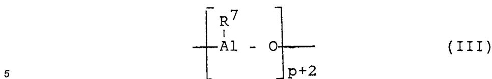
für den cyclischen Typ, wobei in den Formeln II und III R<sup>7</sup> eine C<sub>1</sub>-C<sub>6</sub>-Alkylgruppe bedeutet und p eine ganze Zahl von 5 bis 40 ist, bei einer Temperatur von -78 bis 100 °C 5 Minuten bis 60 Stunden voraktiviert wurde, und wobei der Aktivator ebenfalls ein Aluminoxan der Formeln II oder III ist und Wasserstoff im Molverhältnis 1-Olefin/H<sub>2</sub> von 3 bis 3000 zugegen ist.
