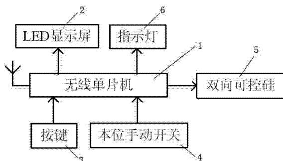
1. 一种基于无线网络的家庭智能开关系统,其特征是:所述开关系统包括多个智能开关,每个智能开关均包括无线单片机(1)、LED 显示屏(2)、按键(3)、本位手动开关(4)、双向可控硅(5)和指示灯(6)共六个部分,其中按键(3)和本位手动开关(4)作为输入设备和无线单片机(1)相连接,LED 显示屏(2)和指示灯(6)作为输出设备和无线单片机(1)相连接,无线单片机(1)还连接着双向可控硅(5)的控制端,由双向可控硅(5)的两个主接线端作为开关的两个接点;所有的智能开关通过其内的无线单片机(1)共同组建成一个 ZigBee 无线网络,并通过 ZigBee 无线网络实现相互间的无线数据通信,其中一个智能开关作为 ZigBee 无线网络的协调器节点,其余智能开关均作为 ZigBee 无线网络的终端节点。
