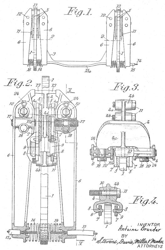
LEVER ACTUATED, SPOT TYPE DISC BRAKE
