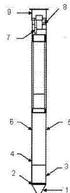
1. 一种可测土体 pH 值的环境孔压静力触探探头,其特征在于在该探头内的上部设有 pH 值测试腔(8)和 pH 值计(7);探头的下部设有测斜仪(6)和三分量地震检波器(5),在三分量地震检波器(5)的下部设有温度传感器(4),在温度传感器(4)的下部是摩擦筒(3),在摩擦筒(3)的下方连接有探头(1),孔压过滤环(2)位于摩擦筒(3)与探头(1)的连接处,触探探头与探杆(9)直径相同,该探头探头上部连接探杆(9)。
