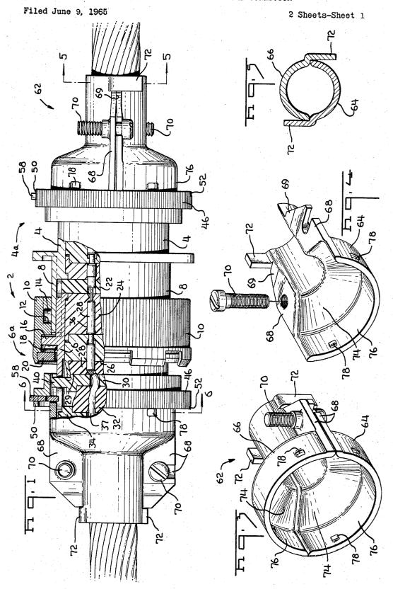
CABLE CLAMP FOR ELECTRICAL CONNECTOR
