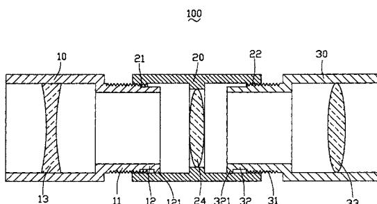
1. 一种镜头模组，其特征在于，包括沿光轴方向顺序设置的第一镜筒、第二镜筒及第三镜筒，所述第二镜筒内设镜片且两端具有内螺纹，所述第一镜筒和 / 或第三镜筒内设有镜片，所述第一镜筒、第三镜筒上均具有能与所述内螺纹配合的外螺纹，所述第一镜筒与第三镜筒分别靠近第二镜筒的一端均轴向延设有一卡合部，所述卡合部上具有沿镜筒径向延伸的凸起，所述第二镜筒两端内螺纹处具有凹槽，使得第一镜筒、第三镜筒的卡合部能够插入第二镜筒中，所述镜头模组将第一镜筒和第三镜筒固定不动，而通过转动第二镜筒来对镜头模组进行调焦。
