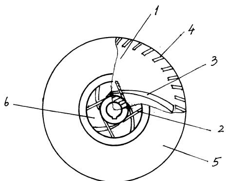
1、一种泵用的多级推进式离心叶轮，由叶轮轮毂和叶轮盖连接构成，叶轮内装有叶片，其特征在于叶轮有相连通的叶轮进水端内腔（6）和叶轮内腔（7），叶轮装有多级叶片，第一级叶片（2）安装在叶轮进水端内腔（6）内，第二级叶片（3）和第三级叶片（4）安装在叶轮内腔（7）内，第三级叶片（4）安装位置在叶轮内腔（7）的边缘，叶轮进水端内腔（6）是由叶轮轮毂（1）和叶轮盖（5）构成的凸出的圆台形空腔。
