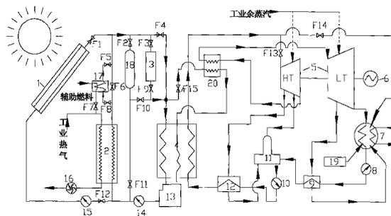
1. 一种考虑余热利用的太阳能热力发电装置,其特征在于:包括以导热油为工质的导热油循环回路和以水为工质的水循环回路,所说的导热油循环回路包括管道中填充有导热油并依次相连的太阳能集热器(1)、余热锅炉(2)、再热器(20)及蒸汽发生器(4),其中太阳能集热器(1)由多个槽型抛物面聚光集热器经过串联或并联组成,太阳能集热器(1)、余热锅炉(2)、蒸汽发生器(4)通过管道并联连接构成闭合回路;所说的水循环回路为包括带有发电机(6)的汽轮机(5),汽轮机(5)通过管道依次与凝汽器(7)、低压加热器(9)、除氧器(11)、高压加热器(12)、蒸汽发生器(4)相连。
