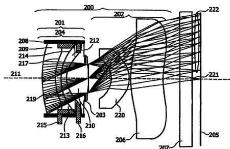
1. 一种光学透镜系统(100、200)，所述光学透镜系统包括一个第一透镜群(101、201)、一个第二透镜群(102、202)和一个光圈(103、203)，至少其中一个所述透镜群包括一个光学元件(104、204)，所述光学元件具有：
