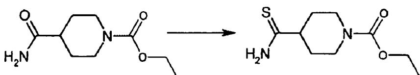
**[0017]** N-Ethoxycarbonylpiperidin-4-carboxamid (6 g, 30 mmol) in Toluol (300 ml) wird mit Lawesson's Reagenz (6,1 g, 15 mmol) bei Raumtemperatur für 18 h behandelt. Das Reaktionsgemisch wird eingedampft und durch SiO<sub>2</sub> Chromatographie (Aceton/Cyclohexan 20/80) unter Bildung der Titelverbindung gereinigt, die aus Hexan (3,6 g, 52,5%) umkristallisiert wird.
