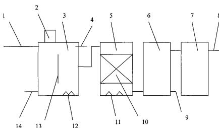
1. 一种小型生活污水处理系统，其特征在于包括集水初沉池、多用途调节池、絮凝沉淀池、气浮池、好氧生物滤池、二次沉淀池和储水池，所述集水初沉池、多用途调节池、絮凝沉淀池、气浮池、好氧生物滤池、二次沉淀池和储水池依次连接，所述多用途调节池底部设有污泥刮板和污泥排污口、上部设有浮油刮板和浮油排污口，所述集水初沉池底部设有刮泥装置和排污口。
