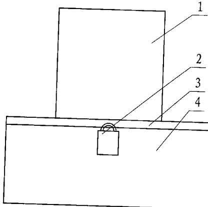
1. 一种分类存钱罐，包括一个圆柱状的筒体，其上端制出用于放钱的进口，其下端制出用于取钱的出口，其特征在于：在筒体的外侧安装一个纸币存储盒，该纸币存储盒上安装端盖，该端盖上制出进钱孔。
