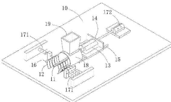
1. 一种用于土豆去皮的新机械,其特征在于:包括用于固定待去皮土豆的插刀,土豆穿插固定在插刀上,插刀的一端与驱动其绕其身长方向进行转动的驱动机构相连接,插刀的另一端外围设置对土豆进行去皮的去皮机构,去皮机构包括插刀外围设置的去皮板,去皮板沿垂直于插刀身长长方向浮动固定在基座上,去皮板靠近插刀一侧的板面上设置由清洁球丝构成的去皮层,插刀上固定的土豆与去平层相张紧擦拭去皮;去皮板为塑性材料构成;插刀为截面为“十”字状的刀具。
