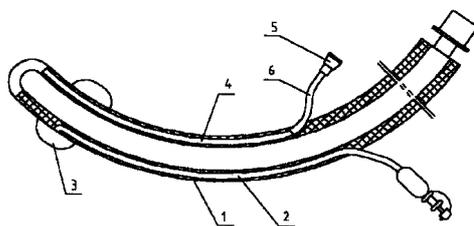
1、一种带湿化侧管的气管插管，包括管体（1），管体（1）的末端部位套装有气囊（3），管体（1）的壁内装有一端与气囊连通、另一端从管体（1）的中段部位外伸的充气小管（2），其特征是在管体（1）上设有一条湿化通道（4），该湿化通道（4）的末端开口于管体（1）末端的小弯侧、首端能与输液器衔接。
