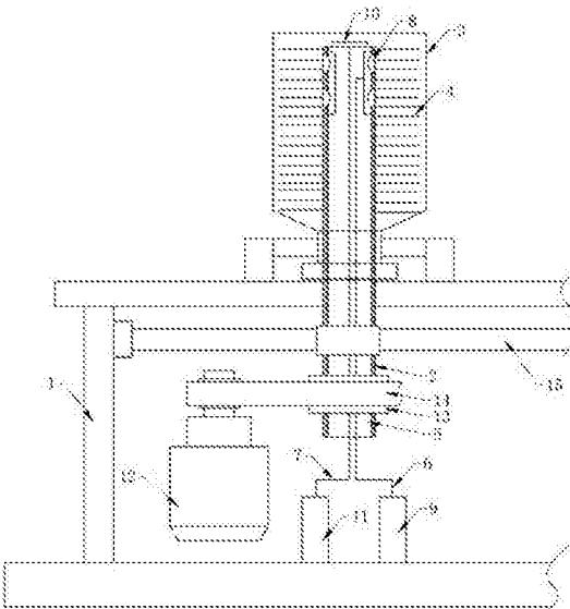
1. 一种生物技术用试剂瓶清洗装置，其特征在于：包括支架，所述支架设置有固定试剂瓶的卡位机构，清洗手柄，所述清洗手柄转动安装，所述清洗手柄的末端外环面上环绕设置有刷毛，所述清洗手柄的内部具有中空腔体，且所述中空腔体内设置有一条进水管和一条进气管，所述清洗手柄的侧壁开设有若干喷水孔，所述喷水孔与所述进水管连通，所述清洗手柄的末端面上开设有若干喷气孔，所述喷气孔与所述进气管相连通；以及动力设备，所述动力设备与所述清洗手柄传动连接。
