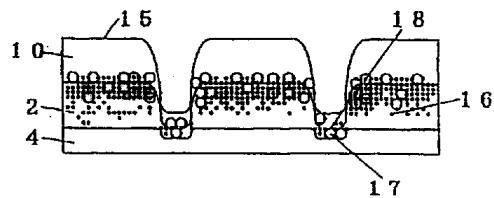
5        1. 一种片状发热体，其特征在于：多层叠合的、具有许多空隙的无纺布，在其中至少一层无纺布上保持发热组份和热熔型粘合剂粉末，该无纺布通过加热压缩机的加热压缩，在该层的无纺布上的至少一个面粘合有另一层无纺布，并浸透水或者无机电解质水溶液。
