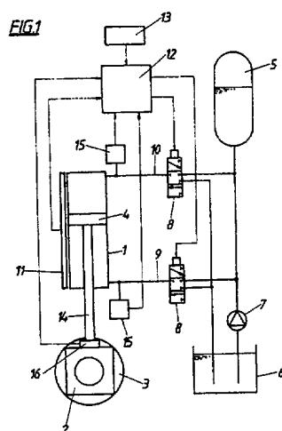
Die Erfindung bezieht sich auf ein Verfahren zur Steuerung eines langhubigen, hydraulischen Stellzylinders, insbesondere eines Anstellzylinders für ein Stauchgerüst, wobei der beidseitig beaufschlagbare, entlang seines Stellweges in verschiedenen Arbeitsstellungen hydraulisch verriegelbare Kolben nach seiner Verriegelung mit einer äußeren Kraft schlagartig belastet wird.
