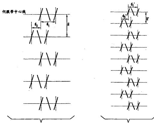
1. 一种伺服写入头，被配置用于在线性磁带上相应的伺服带中同时写入至少两个伺服模式，其中所述伺服模式的中心线在横向中实质上均匀间隔，并且其中所有相邻的相应伺服带的所述伺服模式在纵向中以与伺服帧的长度和所述伺服模式的类型有关的量彼此相对移位。
