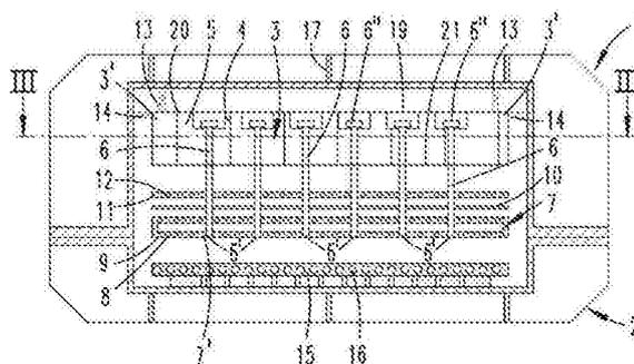
1. 一种CVD或PVD覆层设备,具有壳体(1、2)、固定在壳体(1、2)上的进气机构(7)和固定在壳体(1)的上部区段上的固持装置(3),所述进气机构(7)具有具备排气口(8)的排气面(7'),所述进气机构(7)在多个悬吊位置(6')上固定在固持装置(3)上,其特征在于,设有可主动调温的调温装置(11、12),所述固持装置(3)借助所述调温装置(11、12)能够稳定温度。
