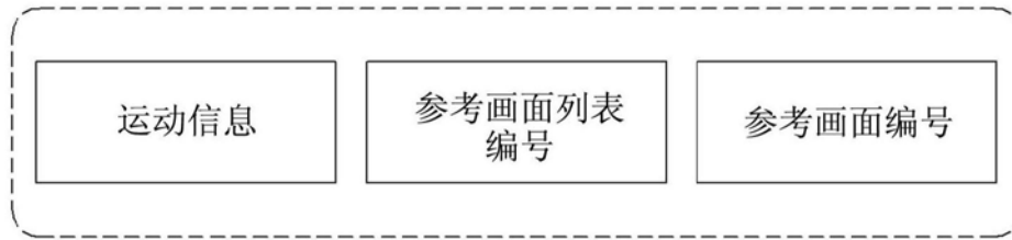
(a) 现有编码器/解码器的帧间预测信息构造的示例
