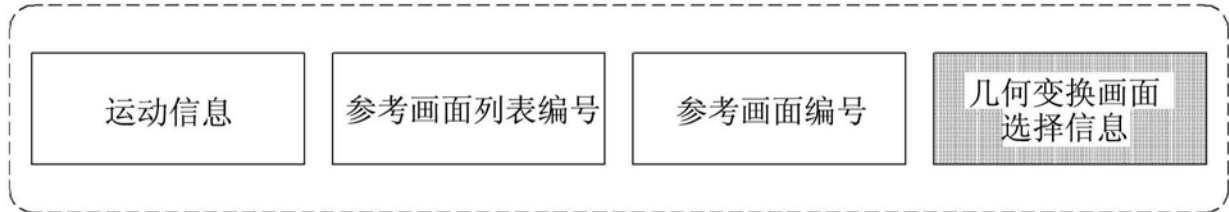
(b) 使用几何变换画面的编码器/解码器的帧间预测信息构造的示例
