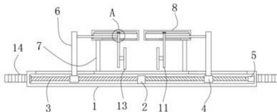
1. 一种计算机显卡支撑机构,包括支撑板(1),其特征在于,所述支撑板(1)的顶部设有凹槽,凹槽的中间位置焊接有固定块(2),固定块(2)的中间位置设有圆孔,圆孔的内壁上转动安装有双向螺纹柱(3),双向螺纹柱(3)的两侧螺纹套接有横块(4),双向螺纹柱(3)的一端与伺服电机(5)的输出轴相固定,横块(4)的顶部焊接有拉板(6),所述支撑板(1)的顶部两侧均焊接有支撑柱(7),支撑柱(7)的顶部固定安装有限位板(8),限位板(8)的中间位置设有限位槽,限位槽的内顶壁上设有滑槽(9),滑槽(9)的内部滑动安装有滑块(10),滑块(10)的底部延伸至滑槽(9)的外部,并且固定有连接板(11),两个连接板(11)相互远离的一侧焊接有连接杆(12),两个所述限位板(8)的底部相互靠近的一侧设有长方形开口,且连接板(11)的下端贯穿长方形开口延伸至限位板(8)的下方,两个连接板(11)相互靠近的一侧下部固定安装有T形板(13)。
