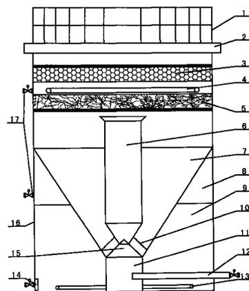
1. 一种一体式水净化装置,包括罐体(16)、进水管路(12)、旋流反应腔(7)、淤泥收集筒(6)、排泥管(13)、过滤层(5)、反水清洗管(4)、滤料层(3)和清水排放(2),其特征是:罐体(16)内设有漏斗形旋流反应腔(7),淤泥收集筒(6)设置在旋流反应腔(7)中部,在旋流反应腔(7)下部的污泥沉淀腔(11)通过排泥管(13)外接排泥电动阀门(17),罐体(16)外引进的进水管路(12)出水端处于旋流反应腔(7)下方的污泥沉淀腔(11)内,在旋流反应腔(7)外部的上部形成上清液室(8)和旋流反应腔(7)外部的下部形成污泥浓缩腔(9);在罐体(16)上部设有过滤层(5),所述过滤层(5)上部间隔设有滤料层(3),所述滤料层(3)上部为清水排放(2)口;其中连接罐体(16)外部的反水清洗管(4)处于过滤层(5)和滤料层(3)之间。
