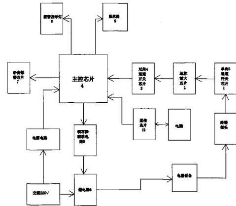
1. 一种具有屏幕显示功能的电器设备漏电监测器,包括有单向8通道开关芯片(1),运算放大芯片(2),双向4通道开关芯片(3),主控芯片(4),锁存器驱动芯片(5),继电器(6),语音报警芯片(7),显示屏(9);所述单向8通道开关芯片(1)输入端与检测电流或温度信号的终端探头连接,单向8通道开关芯片(1),运算放大芯片(2),双向4通道开关芯片(3),主控芯片(4)顺次连接,所述锁存器驱动芯片(5),语音报警芯片(7),显示屏(9)都连接在所述主控芯片(4)上,所述继电器(6)与锁存器驱动芯片(5)连接。
