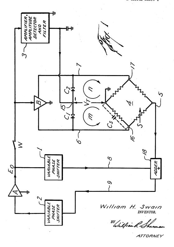
AUTOMATICALLY STABILIZED OSCILLATOR CIRCUITS
