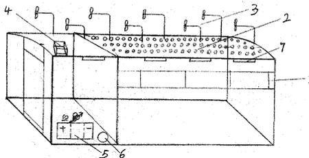
1、一种具有风能太阳能发电节能电动列车，它的构造特征在于它包括：列车车厢主体（1），在每节车厢顶上铺设太阳能吸收转化化学泡膜层（2）并安装有遥控电动机可 180° 旋转的风力发电机组群（3）及水循环储水箱（4），在车内设有高能充电蓄电池组及整流变压转换系统（5），供电力机车用电，太阳能电池（6）供列车电子节能灯照明用电，车顶装有电子节能灯管（7）等主要结构元件组成。
