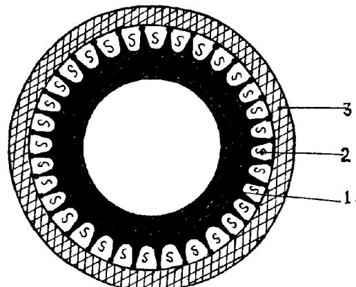
1. 本发明是一种水冷轻型炮管,由复合材料外管和异形金属炮管组成,其特征是 :异形金属炮管是含轴向散热式增强肋的金属炮管 (1)。
