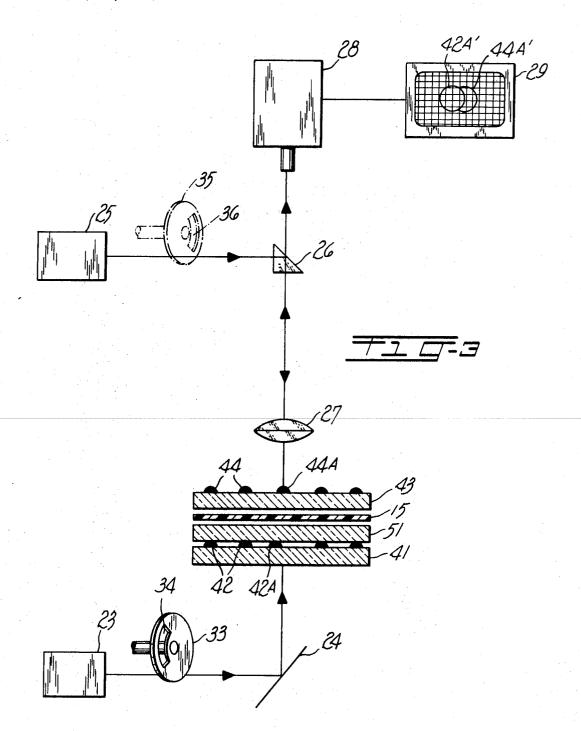
SUPERIMPOSED COMMON CARRIER MASK INSPECTION SYSTEM
