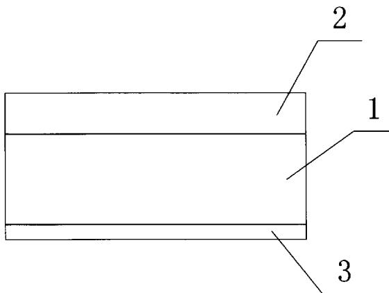
1. 一种防刮伤烟灰缸,包括缸体,其特征在于 :所述缸体顶部设置一缸盖,缸体底面粘接有橡胶垫。
