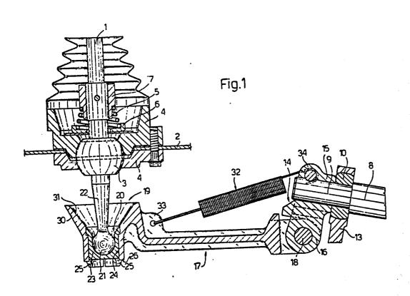
MECHANICAL TRANSMISSION BETWEEN AN INDUSTRIAL VEHICLE GEAR LEVER
