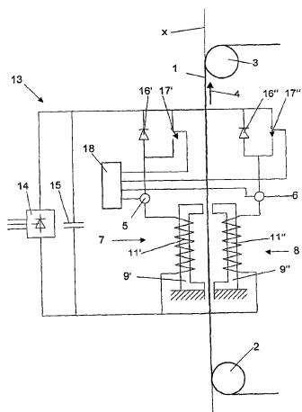
1. 一种稳定磁性材料的细长金属体（1）的装置，使该金属体沿着一平面（X）内的输送轨道（2，3）输送，该平面包括一输送方向（4），并与所述轨道中的物体（1）纵向大致平行，其中，该装置包括一种大致静止的电磁致动元件（7，8），所述致动元件设置成施加一磁力于该物体上并包括至少一个第一致动元件（7）和一个第二致动元件（8），所述第一致动元件包括线圈（11'）并设置在平面（X）的第一侧，并与平面（X）有一确定的距离，所述第二致动元件（8）包括线圈（11''）并设置在平面（X）的第二侧，并与平面（X）有一确定的距离，其特征在于，所述装置包括一传感器（5，6），所述传感器设置成检测随该物体（1）相对平面（X）的位置而定的通过所述线圈的电流值，其中，所述大致静止的电磁致动元件（7，8）设置成响应该检测值把该磁力施加于该物体，该磁力至少包括一分力，作用在该物体（1）上，并垂直于该输送方向（4）和平面（X）。
