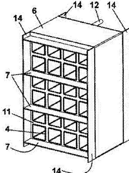
如名称所示，本发明涉及用于供暖锅炉的换热器，所述换热器由外部的棱形框架(1)、燃烧器(2)和排气管道(3)构成，其特征在于，包括由多个管段(5)构成的管块(4)，所述管段(5)沿水平和垂直方向彼此相对地设置，彼此等距离隔开并且集成在棱形壳体(6)中，在所述多个管段之间创建水的闭合回路，在所述多个管段上留空，形成由导流板(7)隔开的不同层面从而控制燃烧产生的气体的流入和流出，按照要求引导所述气体通过所述不同层面，沿着所述气体的路径捕获热量从而快速加热所述回路中的水，而不会损失卡路里，并且尽可能减少燃料消耗。
