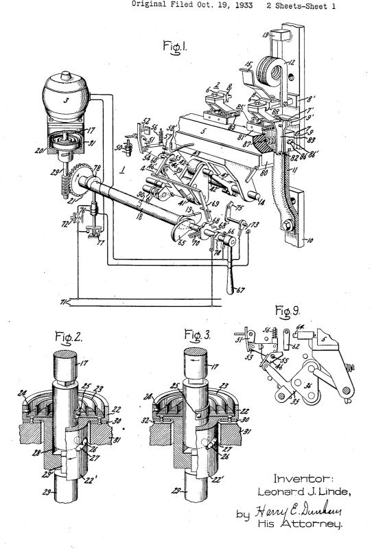
CIRCUIT BREAKER OPERATING AND CONTROL MEANS
