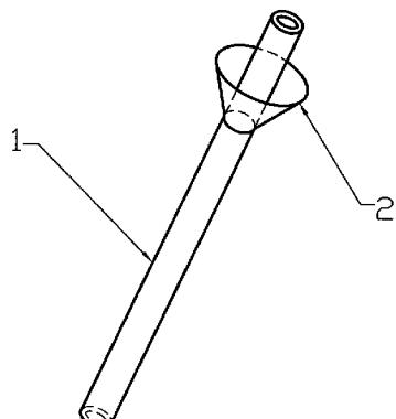
1. 一种吸管筷子，包括筷子本体，其特征是，所述的筷子本体为中空的管状，在筷子本体的上半部设有一个挡片；所述的挡片呈漏斗状，小端位于下方，大端位于上方，小端与筷子本体的外表面固定连接。
