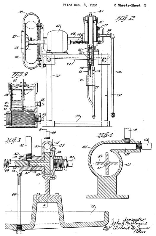
APPARATUS FOR BURNING LIQUID FUEL
