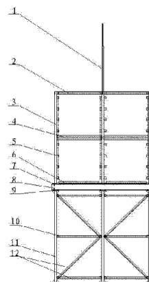
1. 一种水箱型美化天线,其特征在于包括用于固定天线的箱体及用于支撑箱体的支架,所述的箱体包括由箱体方钢(3)构成的长方体或正方体箱体框架及设置在箱体框架框面上的箱体面板(18),所述的箱体方钢(3)下端连接设置槽钢(8),槽钢(8)首尾连接构成槽钢框架,槽钢框架中连接设置用于固定天支抱杆(19)的抱杆连接角钢(14),槽钢框架下方连接设置由支架方钢(11)构成的支架。
