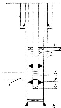
1、一种套管变形油水井修井工艺方法,其特征在于:该工艺方法是采用套变井冲砂技术和砾石充填防砂工艺技术,首先用特制的冲砂工具冲砂到预定位置后,下入特制的防砂工具管柱,在管外充填一定量的石英砂或不进行砾石充填直接完井,实现套变井井眼加固,形成液流或注水通道,达到油井复产,注水井复注的目的。
