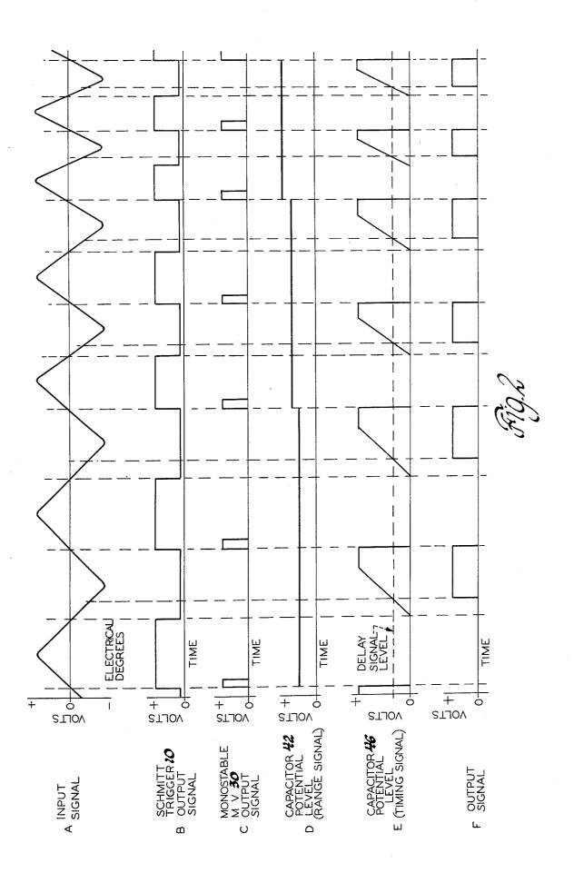
ELECTRICAL ANGLE DELAY CIRCUIT
