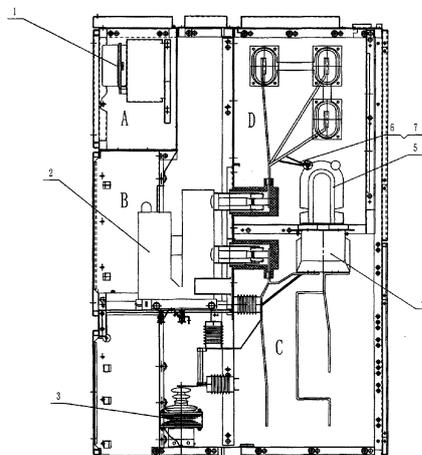
1、一种高压计量装置，由柜体和柜体内的仪表室、母线室、手车室和电缆室组成，各室之间用隔板隔开，所述仪表室内装有计量表计，所述手车室内放有断路器手车，所述电缆室内装有电压互感器和电流互感器，所述母线室内装有母线套管、水平母线和分支母线，其特征在于：所述母线室内还装有自备电源，所述自备电源的A、C两相连接线分别通过软导线连接在所述分支母线上。
