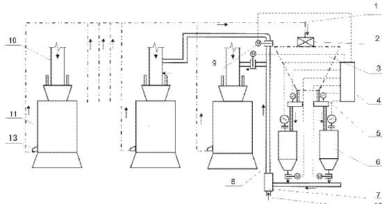
1. 一种一台炉多台中速磨的石子煤自动回收处理装置,其特征在于:包含有回收输送器(1)、除铁器(2)、石子煤贮料斗(3)、PLC 控制器(4)、调频电动给料器(5)、石子煤粉碎机(6)、气力输送器(7)、石子煤粉管(8)、电动煤闸门(9);所述的回收输送器(1)采用气力输送或机械输送,其与全部中速磨煤机(11)的石子煤排弃口(13)相连接;所述的除铁器(2)设置在回收输送器(1)与石子煤贮料斗(3)之间;所述的调频电动给料器(5)设置在石子煤贮料斗(3)与石子煤粉碎机(6)之间;所述的气力输送器(7)连接在石子煤粉碎机(6)之后;所述的气力输送器(7)与原煤管(10)通过石子煤粉管(8)相连接,气力输送器(7)与石子煤粉管(8)的连接处设置有一次风入风口(12)。
